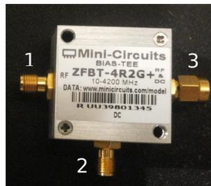
Figura 4.5: Bias-tee utilizzato in laboratorio: il connettore SMA 1 serve per immettere la frequenza; il connettore SMA 2 è utilizzato per fornire la tensione al sensore, mentre l'ultimo connettore SMA è l'uscita .
