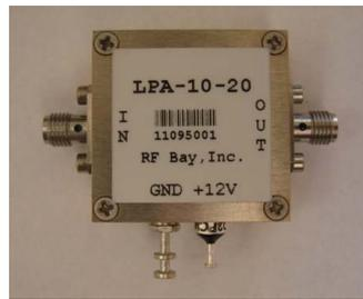
Figura 4.6: Amplificatore utilizzato in laboratorio, con il connettore per il segnale in entrata (IN), il connettore per il segnale in uscita (OUT) e in basso il collegamento a terra (GND) e all'alimentazione elettrica.
