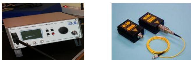
Figura 4.8: Controller del laser con le due teste.
