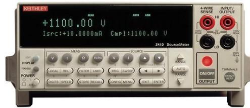
Figura 4.3: Generatore di tensione Keithley 2410.
