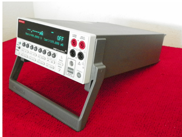
Figura 4.2: Il generatore di alta tensione.
