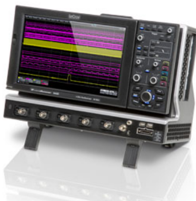
Figura 4.5: Oscilloscopio LeCroy WaveRunner 625Zi.
