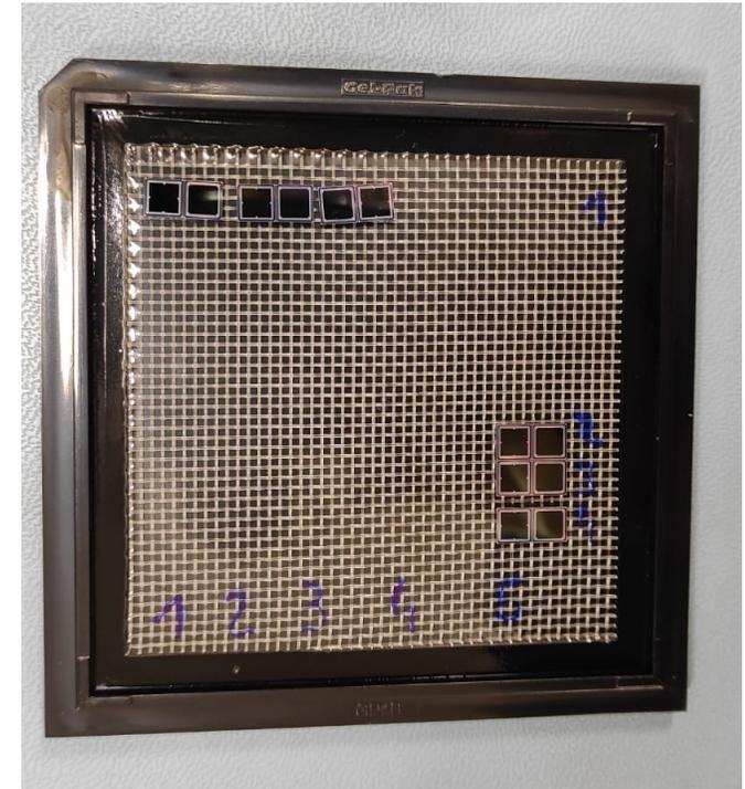
Ho analizzato due sensori per ogni tipologia per un totale di **8 sensori** (4 LGAD di cui 2 primo layout e 2 secondo e 4 PIN anch'esso con entrambi i layout)
