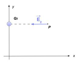
Il vettore campo elettrico  $\mathbf{E_2}$  generato dalla carica  $Q_2$  e valutato sempre nel punto P ha invece **solo componente orizzontale** di modulo :
