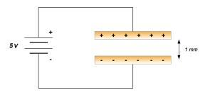
Dal testo del problema sappiamo che il circuito proposto è formato da un condensatore di capacità  $C=2~\mu{\rm F}$  collegato in parallelo ad una batteria di 5 V.
