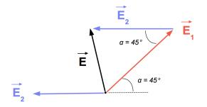
Per verificare la correttezza del nostro risultato proviamo a ricalcolare il <u>modulo</u> del vettore campo elettrico risultante usando invece il <u>prodotto scalare</u> tra vettori, infatti :
