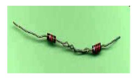
sottoponendo tre resistenze R1, R2, R3 a una tensione V, ho d.d.p.  $V_{R1}$ ,  $V_{R2}$ ,  $V_{R3}$  diverse tra di loro. Le  $R_i$  sono attraversate dalla stessa corrente
