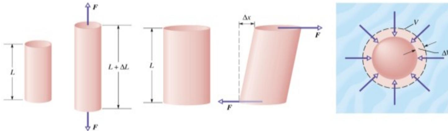
Quando un corpo è soggetto ad una forza di piccola intensità (carico), esso subisce **una deformazione proporzionale al carico**. Tale deformazione è elastica.
