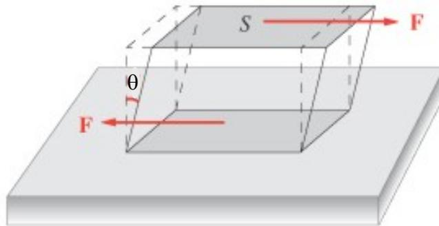
Un cubetto di ferro di  $1 \text{ cm}$  di lato è soggetto a un processo di scorrimento per effetto di un carico specifico  $\sigma$ , raggiungendo una situazione di equilibrio con  $\theta=10^{-3} \text{ rad}$ . Determinare il valore della forza di taglio sapendo che il valore di  $G$  per il ferro è  $G=8 \cdot 10^{10} \text{ N/m}^2 \cdot \text{rad}$
