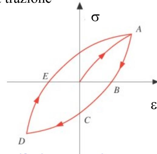
Quando siamo al punto A riduciamo la forza di trazione: *non viene più ripercorsa la stessa curva  $\sigma(\varepsilon)$*  ma la sbarra resta più deformata, e per  $\sigma=0$ , si ha  $\varepsilon < 0$ .
