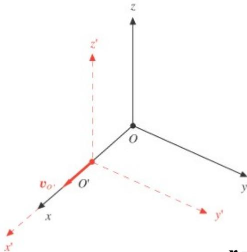
Riprendiamo il primo caso studiato.  $O'$  si muove lungo una **traiettoria rettilinea** Supponiamo il moto traslatorio lungo l'asse  $x$  (che coincide con l'asse  $x'$  come mostrato in figura)  $\Rightarrow \boldsymbol{\omega} = 0$
